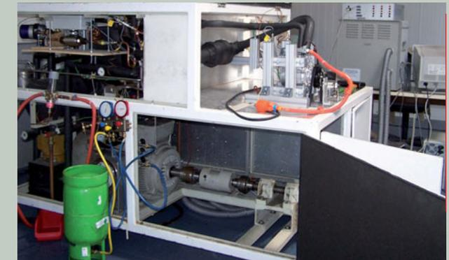
Prüfstand für Pkw-Klimaverdichter
