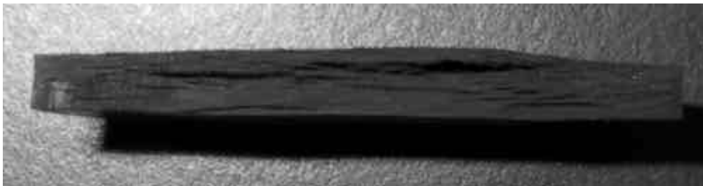
Bild 4. Zerstörung einer Kunststoffprobe durch explosive Dekompression [Eaton Fluid Power]
