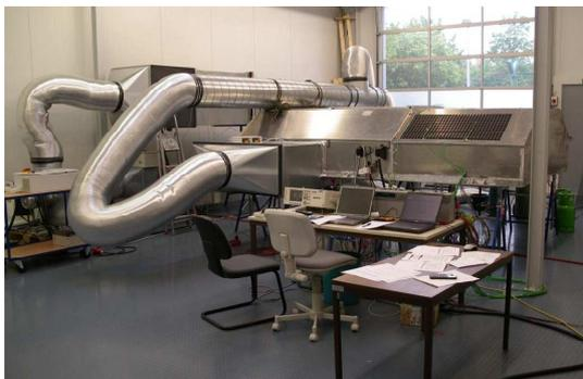
Bild 1. Leistungsnachweis einer Aufdach-Bahnklimaanlage für eine Herstellerfirma
