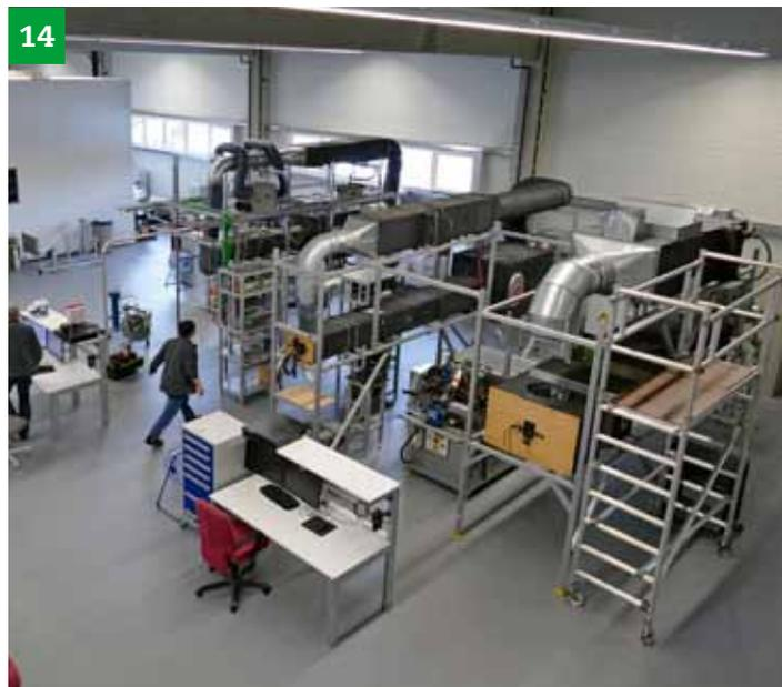
Die Abwärme aus den acht Prüfständen wird dem Latent-Energiespeicher in seiner Funktion als Wärmesenke zugeführt. Der Speicher ist zudem Wärmequelle für die Beheizung des Gebäudes über die Wärmepumpen.
