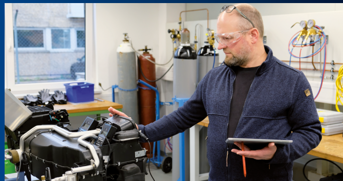
Überprüfung der Ausblastemperatur an einer Kfz-Klimaanlage durch einen Kursteilnehmer
